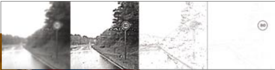
Darstellung des Originalbildes und der Vorverarbeitungsschritte Bildverbesserung, Bildsegmentierung und Bildklassifizierung
